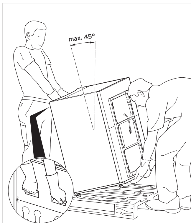
Fig. 4.6 Trasporto della pompa di calore (a mano)
