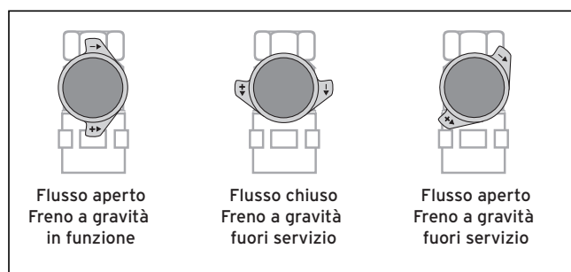
Fig. 3.3 Le tre posizioni del rubinetto a sfera con freno a gravità integrato o della valvola a 3 vie
