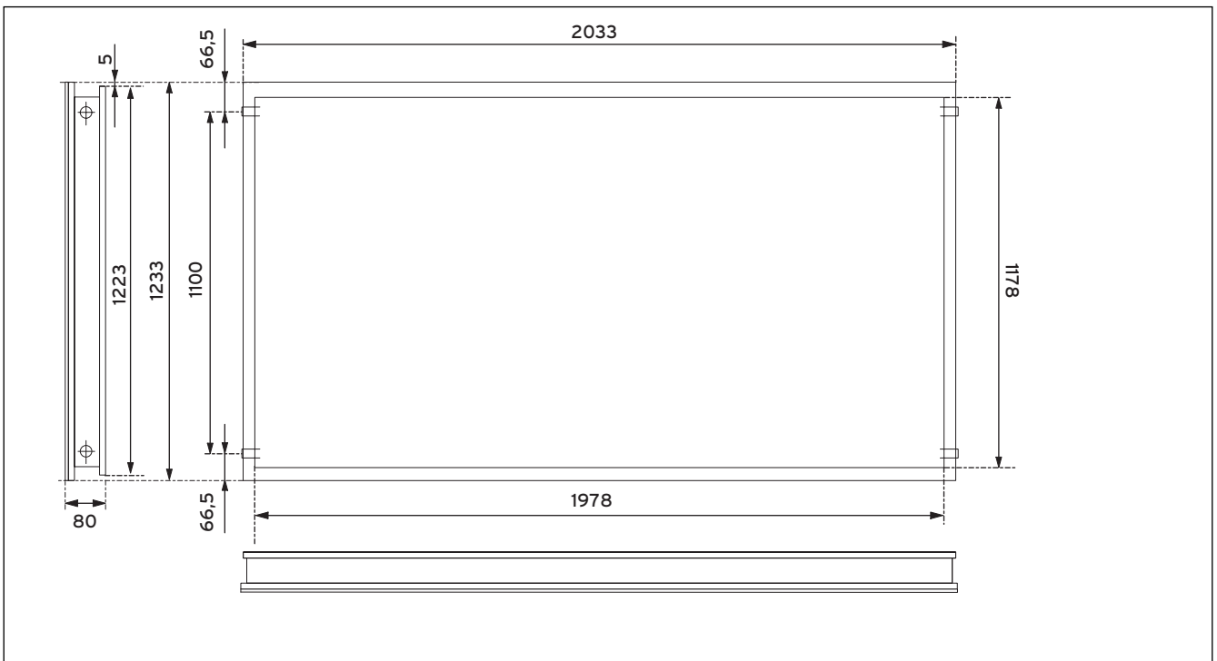
Fig. 12.2 Disegno quotato VFK 145 H, VFK 150 H
