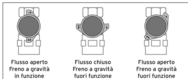
5.1 Posizioni del rubinetto a sfera con freno a gravità integrato o della valvola a tre vie
