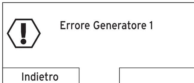
Se la centralina visualizzerà sul display un messaggio di errore al posto della finestra base, premendo il tasto di funzione sinistro **Indietro** comparirà nuovamente sul display l'indicazione base.
