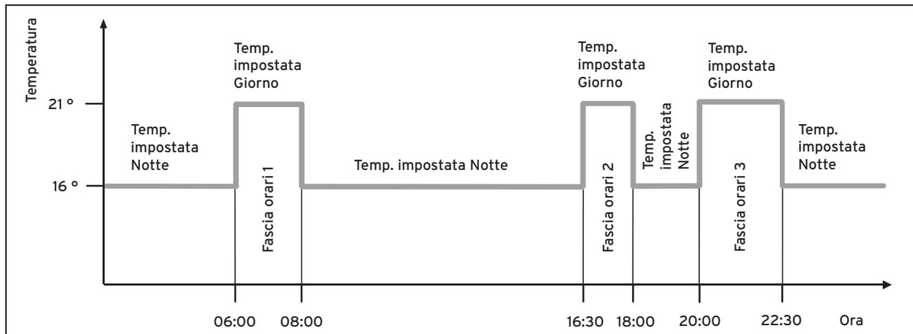
La funzione **Programma tempi** consente di impostare le fasce orarie per il circuito di riscaldamento e la produzione di acqua calda.
