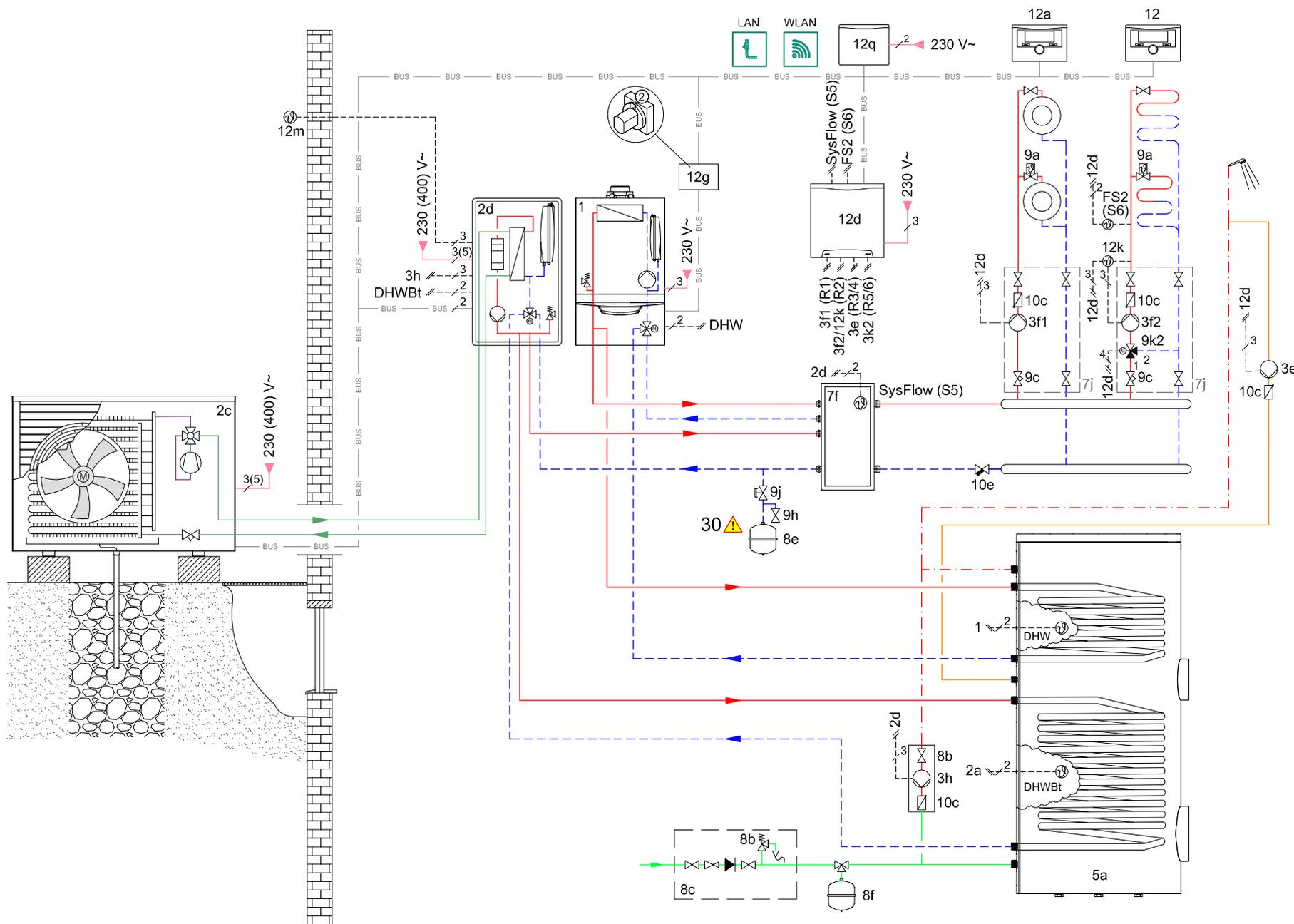
**Attenzione! Schema di principio! Raccomandazione non obbligatoria del produttore!**
